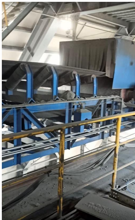
Slika 2. Reverzibilni trakasti transporter 4#
