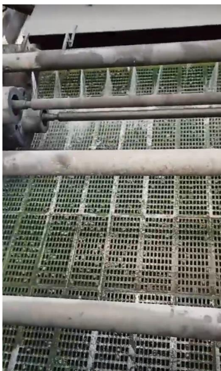
Slika 8. Vibro sito na izlazu iz SAG mlina
