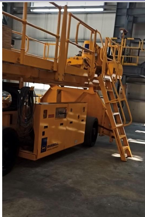
Slika 9. Robot – manipulator za opsluživanje SAG mlina
