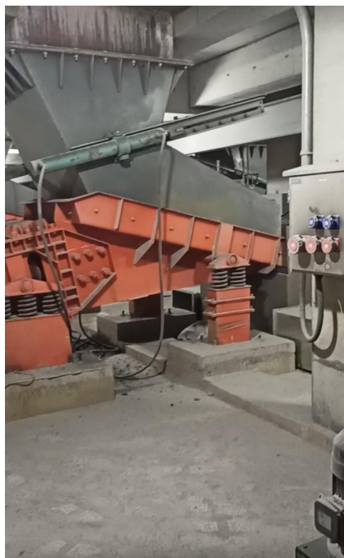
Slika 4. Vibro dodavači ispod skladišta primarno izdrobljene rude
