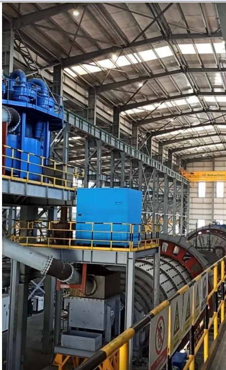
Slika 7. Mlin sa kuglama i SAG mlin
