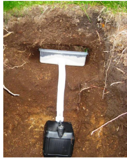
Слика 12. Инсталиран лизиметар са колектором за земљишни раствор на дубини~ 25цм (Ориг.)
