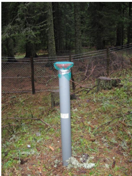
Слика 9. „Throughfall“ колектор на огледном пољу, БИТ Ниво 2, Копаоник
