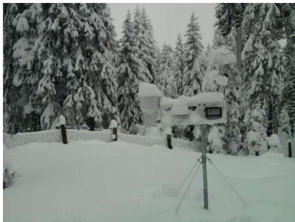
Слика 13 Метеоролошка станица за аутоматска мерења микроклиматских услова, Огледно поље Нивоа 2, Копаоник (2012.год)
