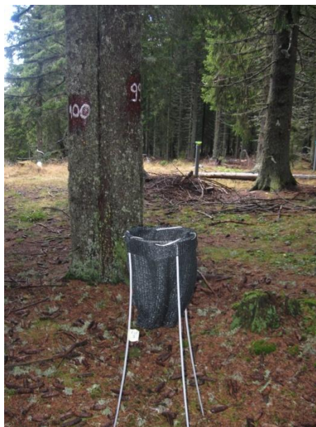
Слика 8. Колектор за сакупљање четина – лисног опада БИТ Ниво 2, Копаноник Figure 8. Needle – litterfall collector on the Level II sample plot Kopaonik
