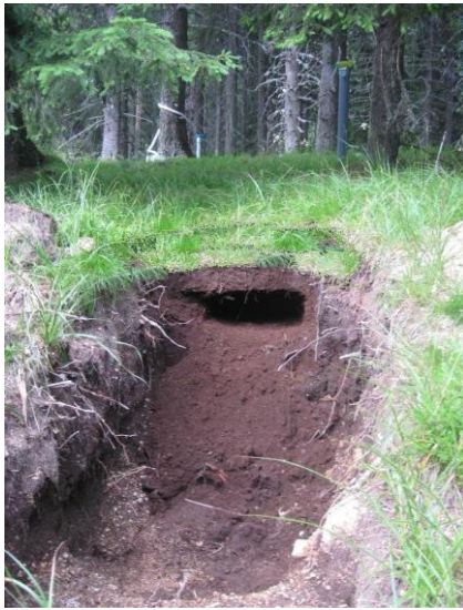
Слика 11. Припрема земљишног профила за инсталацију гравитационог лизиметра Огледно поље БИТ НИВО 2 Копаоник
