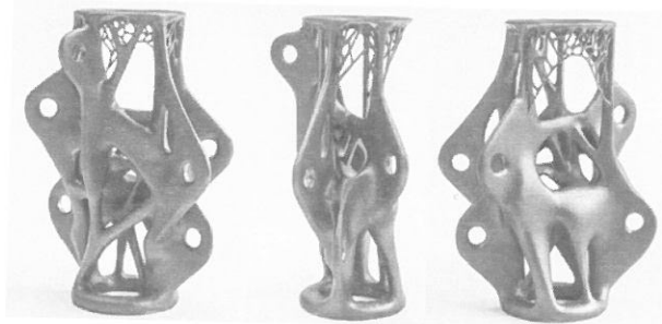
Slika 17.- Čelična legura koja se ugrađuje primenom 3D štampača metodom kap po kap
