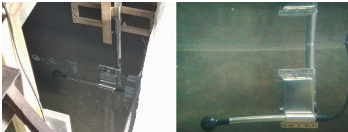
Slika 3. Levo) Kalibracija 3D EM sonde, pogled iz vazduha; Desno) Kalibracija 3D EM sonde, pogled pod vodom
