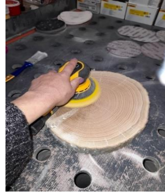
Slika 18 – Brušenje kotura crvenog hrasta
