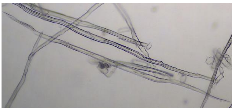
Slika 26 - Drvno vlakno pod mikroskopskim sočivom uvećanja 40x
