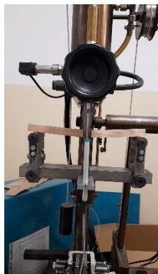
Slika 38 – uređaj za merenje savojne i pritiskne čvrstoće
