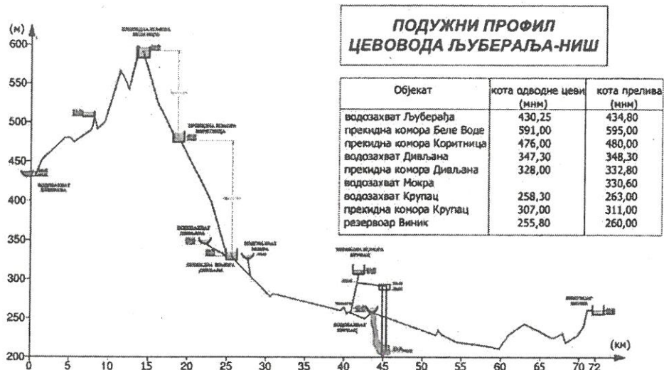
Слика 1. Подужни профил цевовода Љуберађа – Виник са висинским приказом положаја врела и прекидних комора
