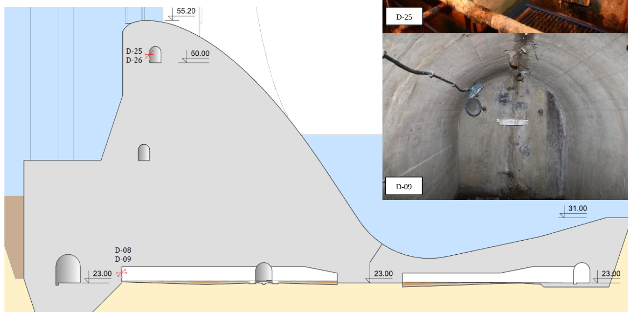
Слика 13. Попречни пресек кроз осу ламеле 3 бране ХЕ „Ђердап 1“ са приказом положаја мерних места на дилатационој разделници [82]
