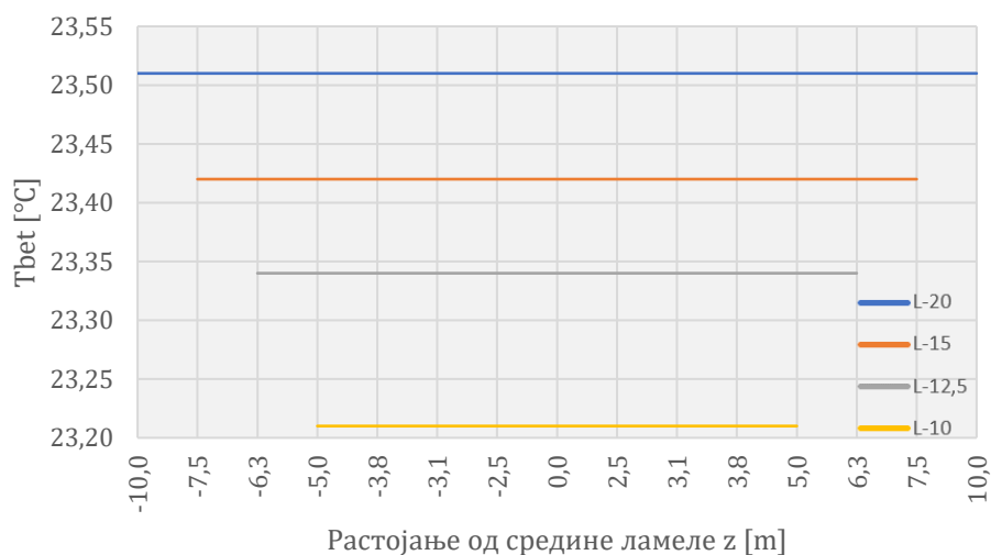
Слика 77. Температуре у бетону у средини хоризонталног пресека на 170,50 мпм (ка обалама реке) за ламеле различитих дужина (1804. дан)
