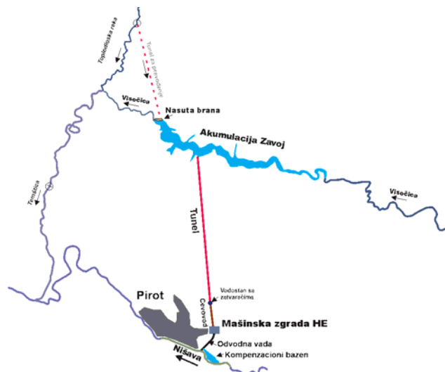
Slika 2. Dispozicija vodoprivrednog sistema Pirot sa ključnim elementima
