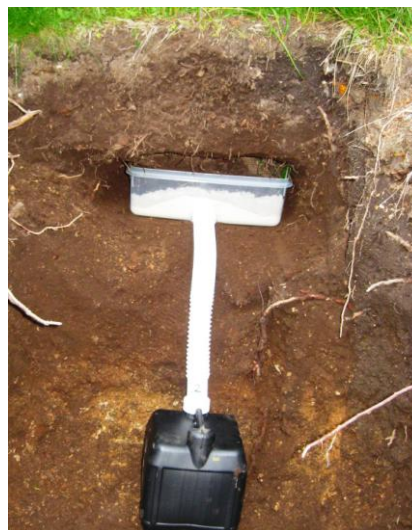
Слика 21. Инсталиран лизиметар са колектором за земљишни раствор на дубини ~ 25cm (Ориг.) Figure 21. The installed lysimeter with a collector for the soil solution at a depth of 25 cm (Orig.)
