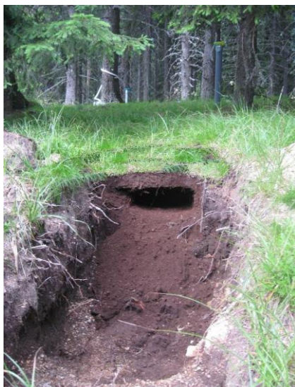
Слика 20. Припрема земљишног профила за инсталацију гравитационог лизиметра Figure 20. Soil profile preparation for the installation of the gravity lysimeters
