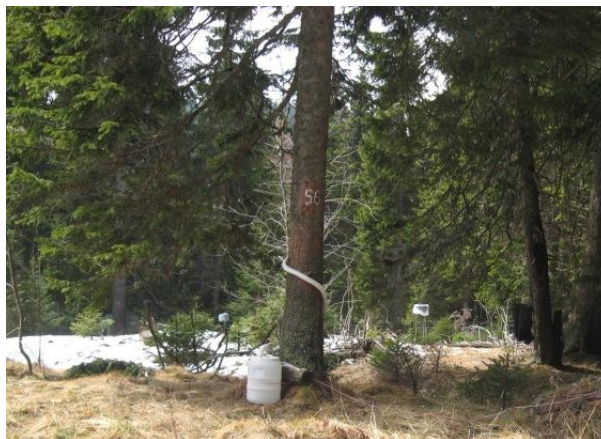
Слика 19. „Steamflow колектор“ на огледном пољу, Нивоа II Копаоник Picture 19. Stemflow collectors- Огледно поље Копаоник
