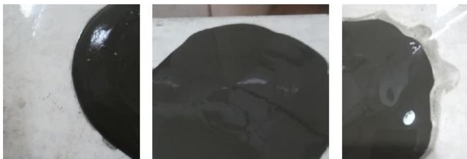
Slika 3. Tečljivost i segregacija jalovine u zavisnosti od sadržaja čvrstog: levo 76%; u sredini 74%; desno 72%
