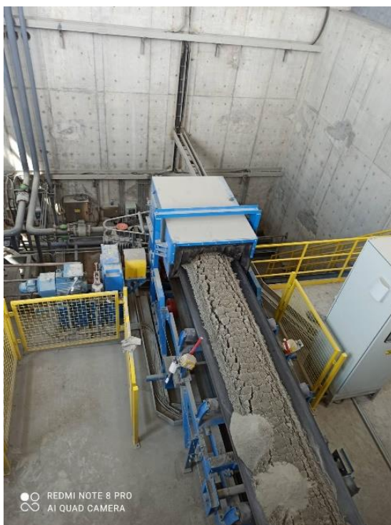
Slika 8. Trakasti transporter za suhu jalovinu
