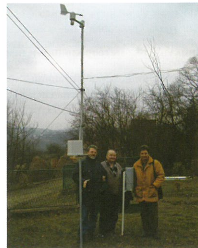
Слика 3 Сензори аутоматске метеоролошке станице и pluviometer
