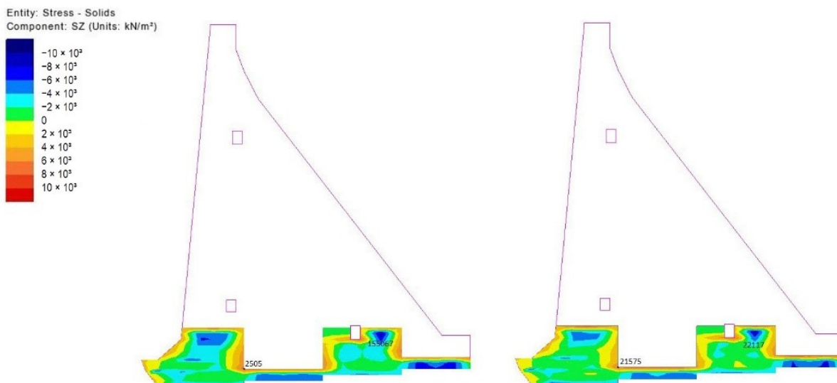
Slika 6. Prikaz napona \sigma_z u srednjoj ravni lamele dužine 20,0 m (levo) i 15,0 m (desno) za 84. dan (10. januar druge godine) [3]
