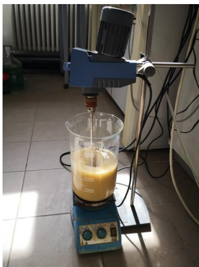
Slika 2. Eksperiment luženja zlata na laboratorijskoj opremi
