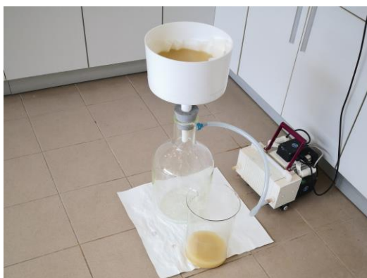
Slika 3. Filtriranje pulpe na Bihnerovom levku
