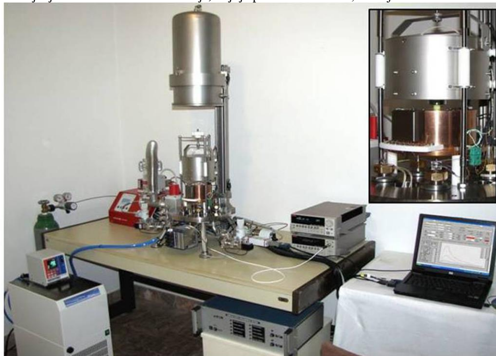
Slika 1. Izgled Z merača; umetnuta slika u gornjem desnom uglu prikazuje topli i hladni blok sa uzorkom smeštenim između (Bernik i Pribošek, 2013)
